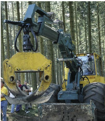
Montée sur un bras télescopique, cette pince peut aller chercher des bois plus éloignés.
