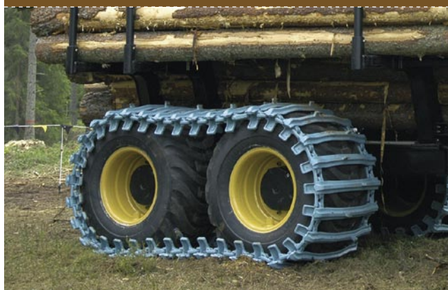
L'usage de tracks permet de diminuer les impacts sur le sol.
