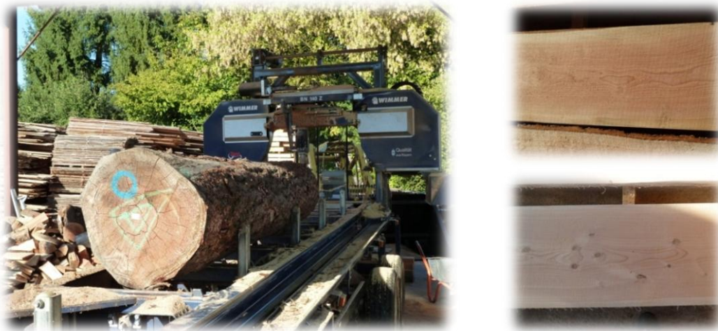
Figure 4. Une grume de douglas de 80 cm de diamètre de très belle qualité extérieure (classé en catégorie A sur pied) n'est pas synonyme de belle qualité interne. En haut à droite, le premier avivé est de très belle qualité. Dès le deuxième avivé, en bas à droite, de nombreux nœuds noirs apparaissent.
